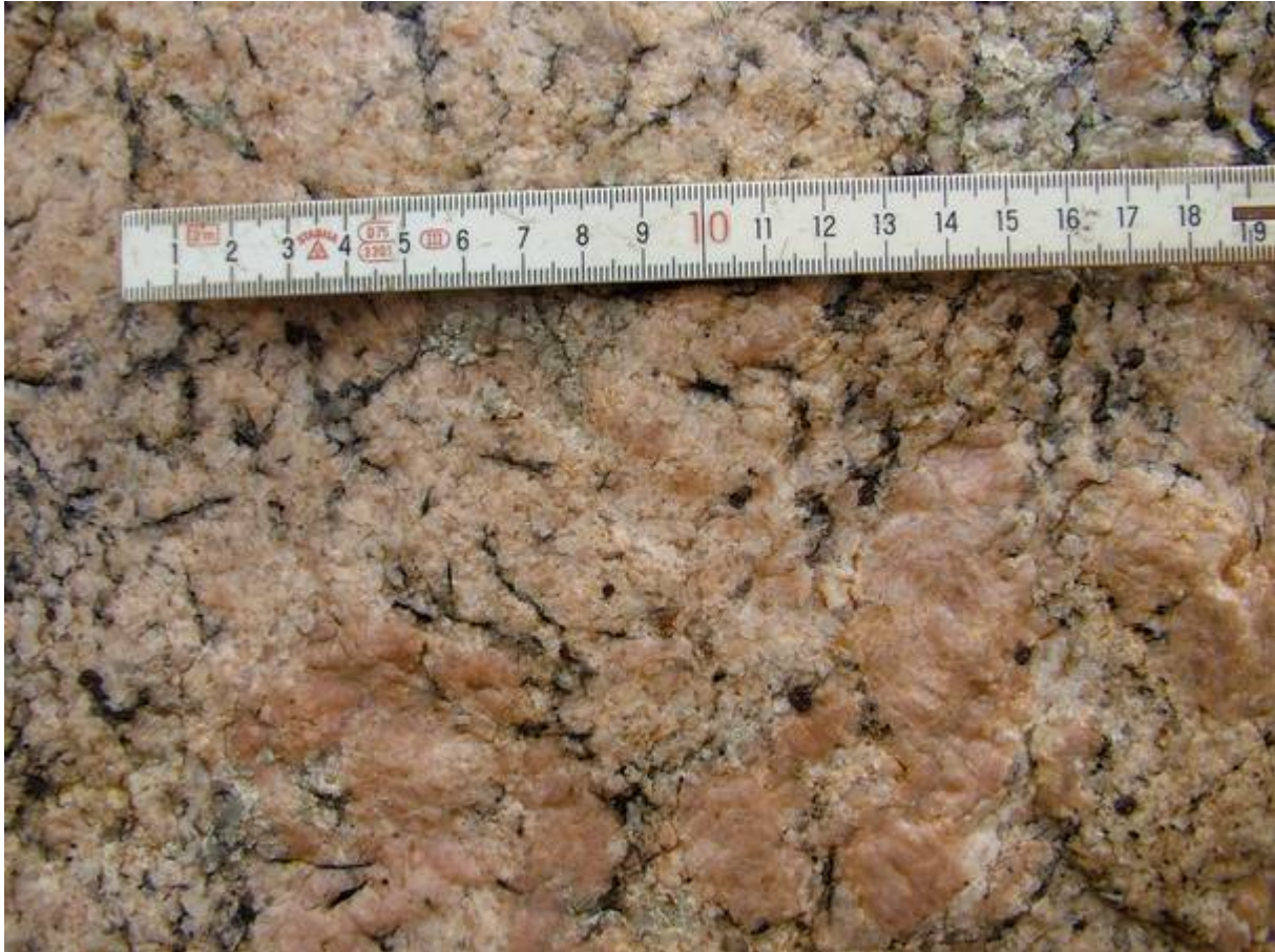
Abb. 2: Grobkörniger Pegmatitgranit mit Feldspäten (rötlich), Quarz (grau) und Biotit (schwarz), Ausschnitt von der Westseite
